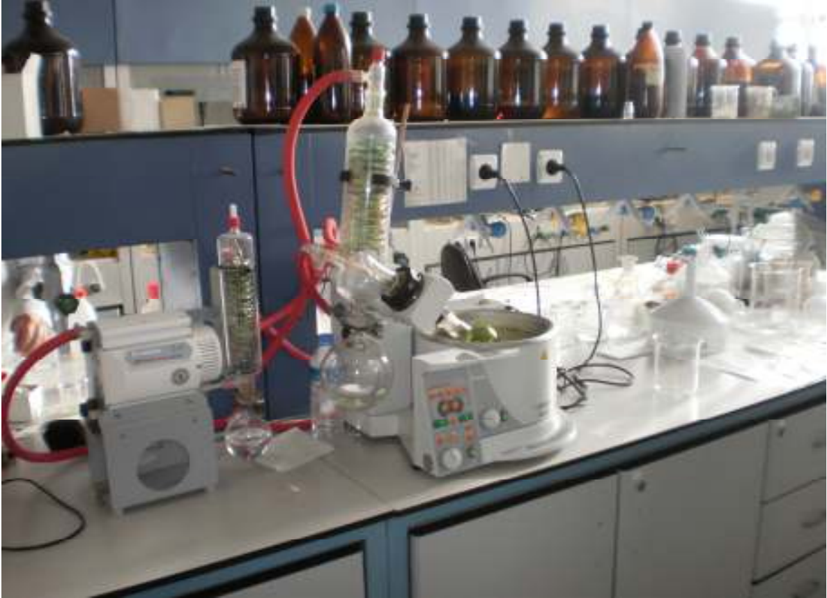
Elde ettiğimiz klorofil – benzen karışımını ayırdığımız evaporatör
