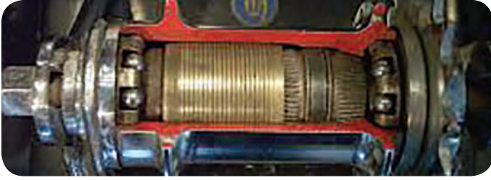
Görsel 1.14.b. Vites ve kontra pedal sistemi
