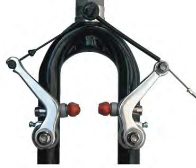
Görsel 4.49.a. Cantilever fren sistemi
