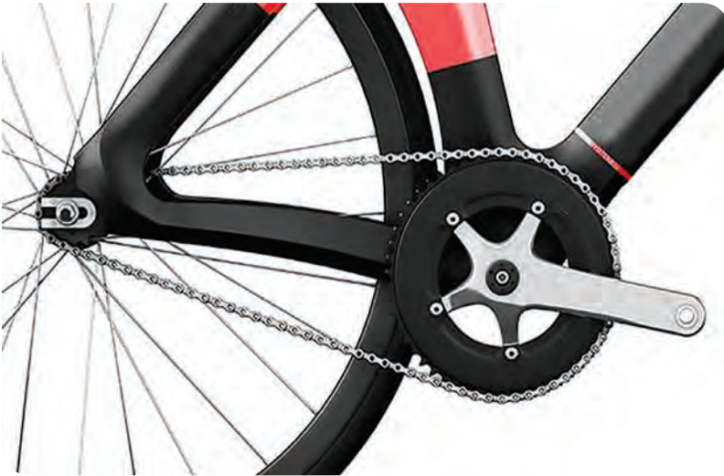
Görsel 2.20.a. Pedal ve fix dişli bölümü
