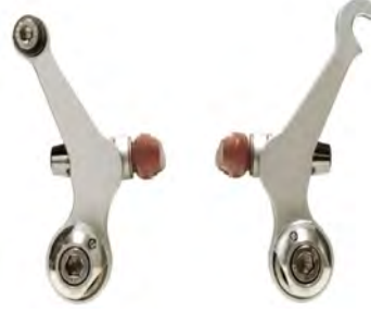
Görsel 4.49.b. Cantilever fren sistemi
