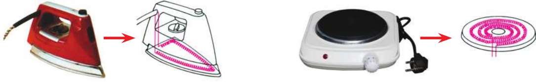
Resim 7.11: Elektrik enerjisinin ısı enerjisine dönüşmesi
