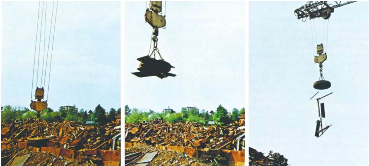
Resim 7.2: Metal atıkların mıknatıs yardımı ile toplanması
